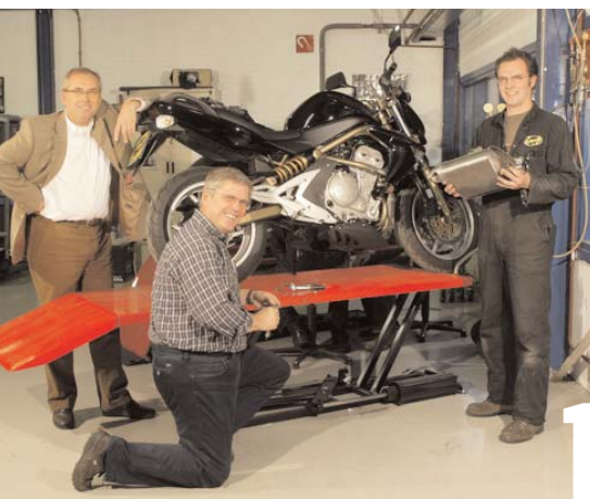
Das Problem: Die Kawasaki ER-6n sieht eigentlich gut aus, aber die JAMA-Bosse M.A. und J.A. van Deyzen (von links) stört der unterm Motor montierte Schalldämpfer. Techniker Wiebe van Doorne hat das 6,6 Kilo schwere Original schon abgebaut
